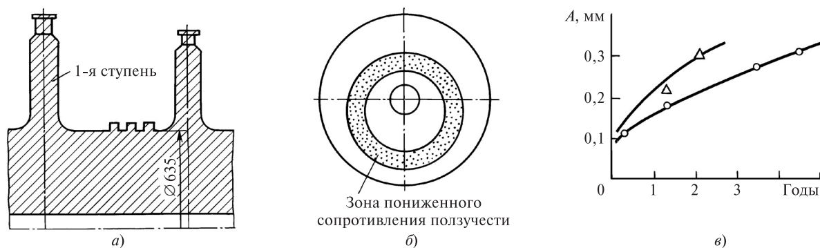
Рис. 19.8. Появление вибрации ротора вследствие асимметрии сопротивления его материала ползучести
