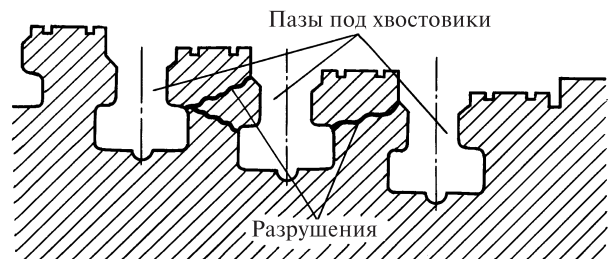
Рис. 17.5. Разрушение хвостовых соединений вследствие исчерпания длительной прочности
