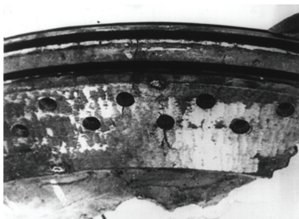
Рис. 17.14. Трещины коррозии под напряжением в отверстиях под заклепки вильчатого хвостового соединения
