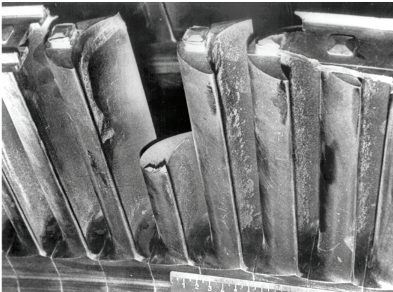
Рис. 16.4. Усталостная трещина на гладкой поверхности лопапки
