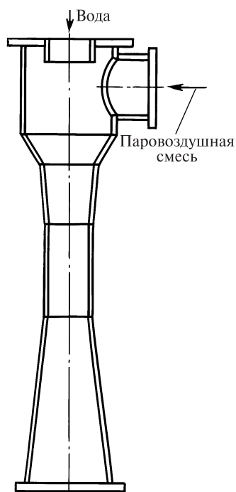
Рис. 5.23. Схема водоструйного эжектора ЭВ-1-350 ЛМЗ
